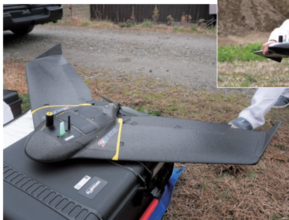
今回の撮影で使用された固定翼 ドローン senseFly の eBeeX
