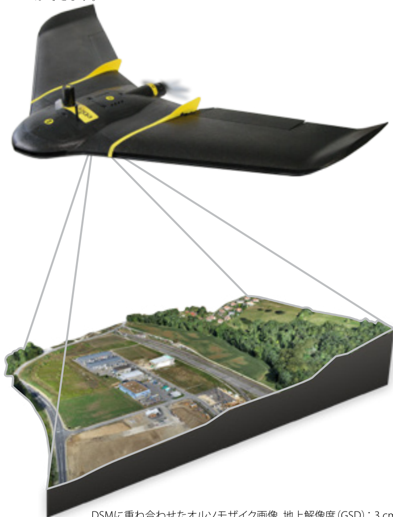
DSMに重ね合わせたオルソモザイク画像 地上解像度 (GSD) : 3 cm /pixel 撮影範囲: 72 ha. 飛行高度: 122 m 対地高度 (AGL)
