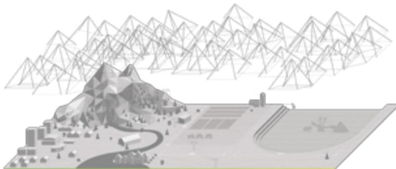
albrisが着陸したら、画像処理を始める前に、eMotionに搭載されているフライトデータマネージャーを使用して、画像の前処理、ジオタグ付けおよび構築を行います。
